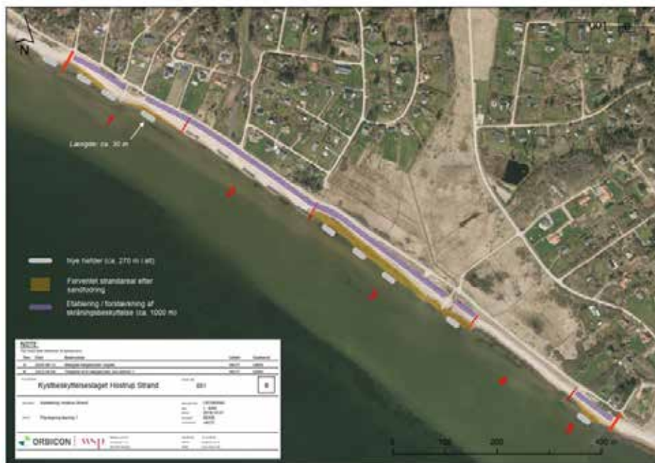
Figur 1. Hostrup Strand Kystbeskyttelseslag har planlagt en udvidelse af den eksisterende beskyttelse ved etablering af de viste 9 bølgebrydere (på figuren er de anført som hælter) og en initial sandfodring samt en forbedring af de 5 eksisterende bølgebrydere. Bølgebryderne placeres på strækningen mellem Rådyrslugten i nord og Teglværksvej i syd.
